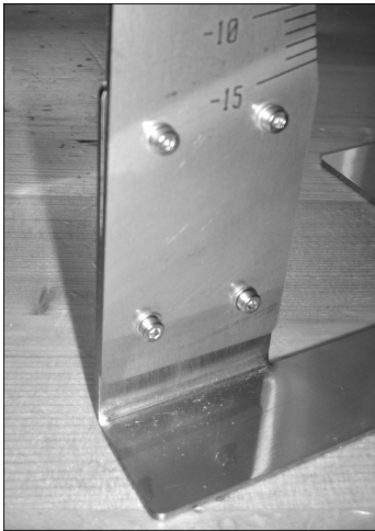
Falsch zusammengebaute Messlehre. Die Kanten der Befestigungszunge und des Skalenträger stehen nicht parallel. Dies kann zu Messfehlern führen.
