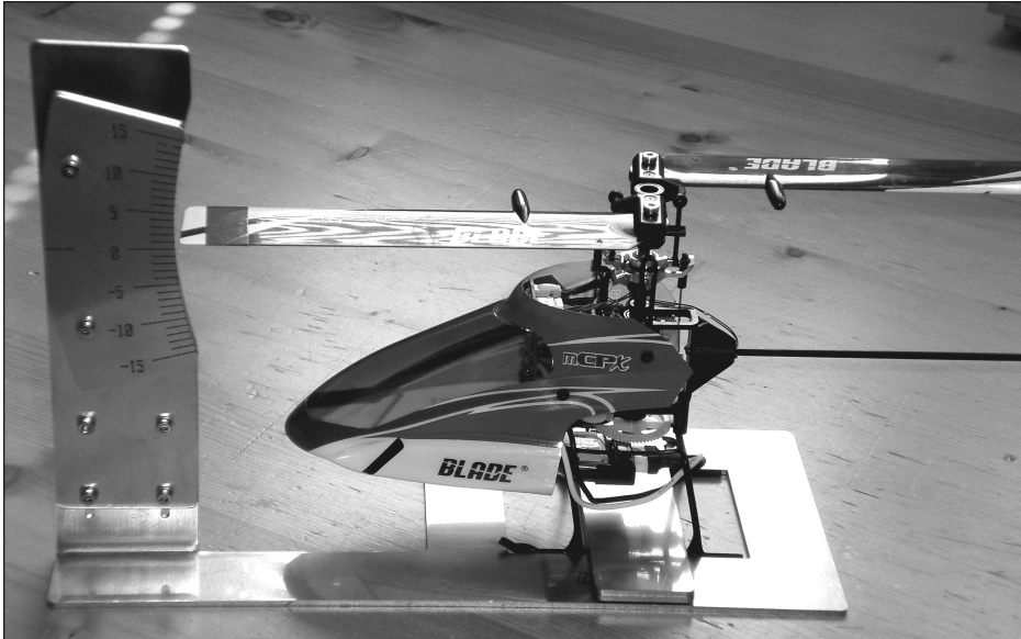
Die Messlehre in Grundstellung – der mCPX steht im Grundrahmen – die Rotorblätter zeigen auf den Null-Wert der Skala
